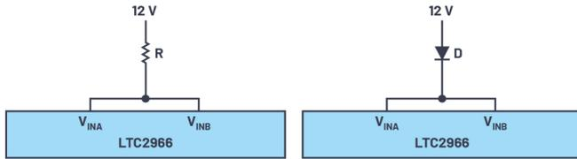
图5. 适用于LTC2966的反向电压保护方法。
