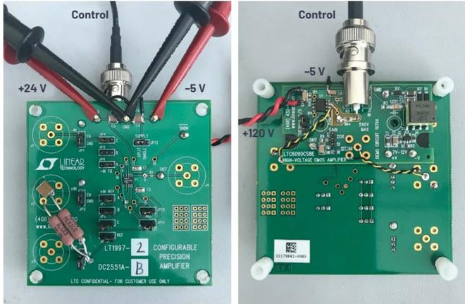
图13. LT1997-2评估板和安装在底部的LTC6090评估板。
