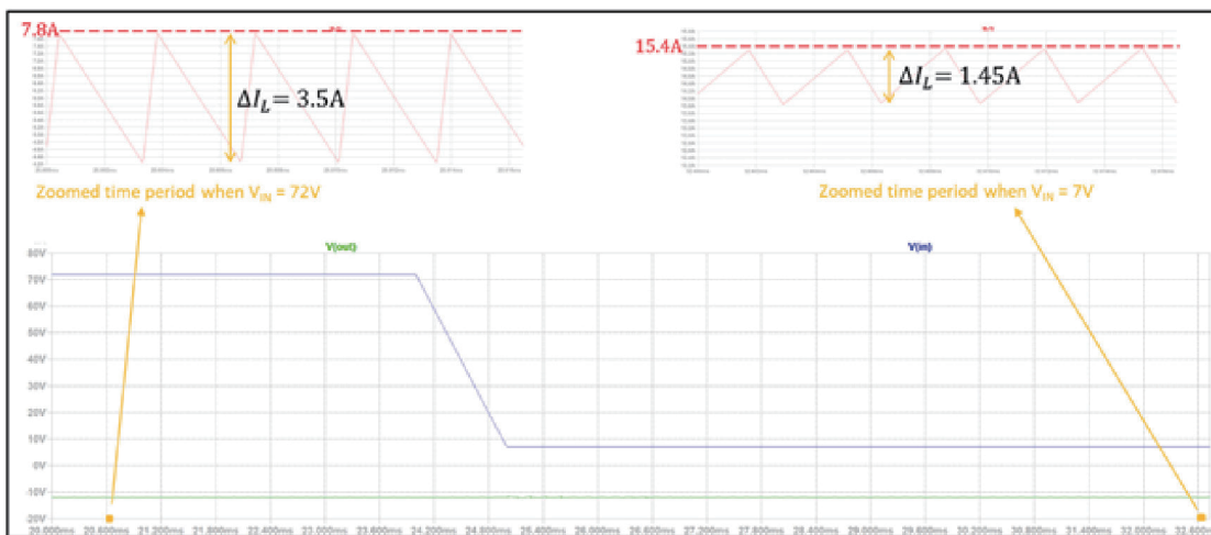
图10. 测量 V_{IN} = 7V 和 72V 时 \Delta I_L 的值，使用之前的LTspice电路获取峰值线圈电流。
