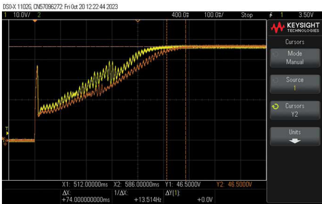
图9. C_6 = 2.2 \mu\text{F} ，负载电流从0.19 A变为0.38 A时的启动时间变化。
