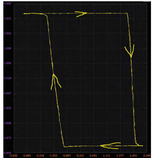
图15 带不对称阈值的反相迟滞比较器的XY图。
