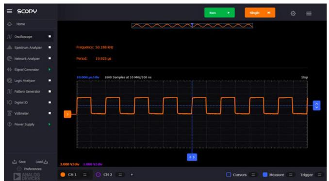
图13. 半量程输入电压下电压频率转换器用作ADC。
