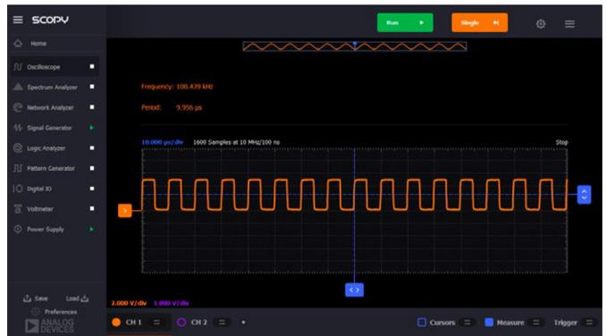
图12. 满量程输入电压下电压频率转换器用作ADC。
