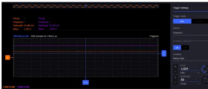
图22.  $V_{IN}$  (通道1) 和  $V_{REF}$  (通道2) 电压。
