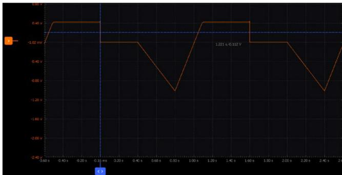
图31. 双斜率ADC积分器波形。
