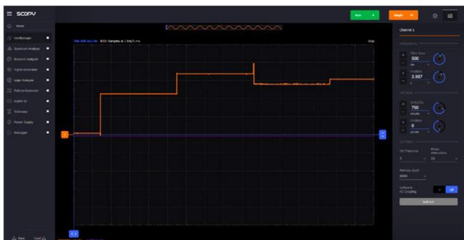
图18. SAR ADC逐次逼近波形。
