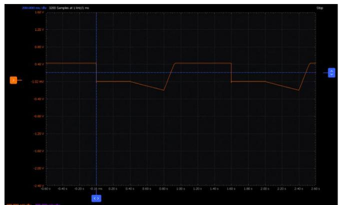
图32. 不同输入电压的双斜率ADC积分器波形。
