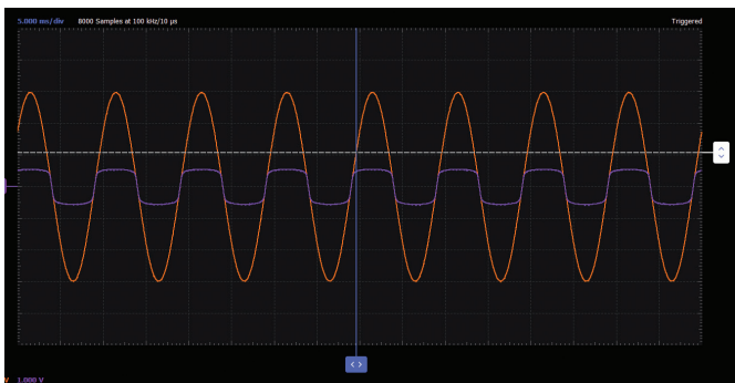
图17. 二极管箝位波形
