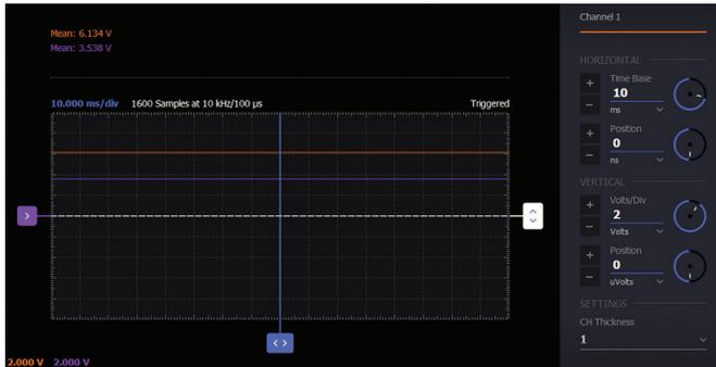
图3.  $R_L =$  开路齐纳二极管稳压器波形
