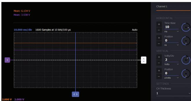
图4.  $R_L = 10$  k $\Omega$ 齐纳二极管稳压器波形
