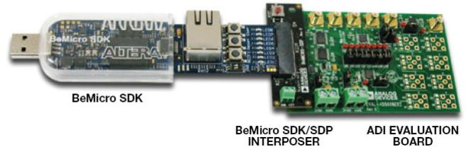
图 6. BeMicro SDK/SDP 转接板连接子板与 BeMicro SDK
