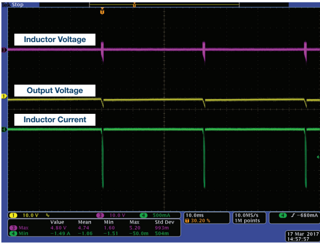
图4. 打嗝模式下的ADP5071反相稳压器
