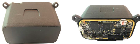
图4. 使用集成式16通道ADAL6110-16的EVAL-ADAL6110-16 LIDAR评估模块。
