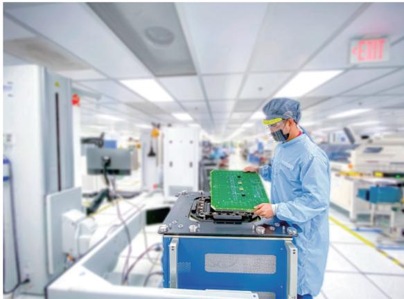
图1. 操作员将负载板安装到测试仪上，以测试数字SoC。
