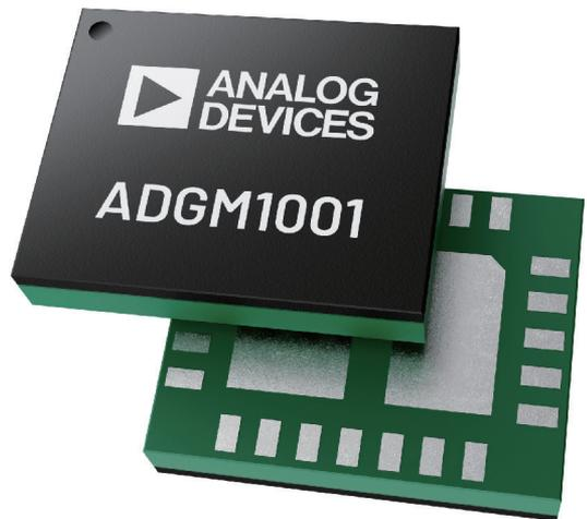
图7. 封装类型： $5 \text{ mm} \times 4 \text{ mm} \times 0.9 \text{ mm}$  24引脚LGA封装。
