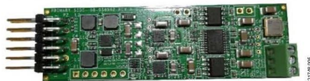
图5. EVAL-CN0531-PMDZ参考设计板照片
