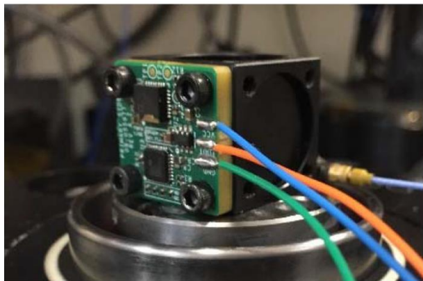
图3. 利用EVAL-XLMOUNT1将EVAL-CN0533-EBZ安装到振动台上
