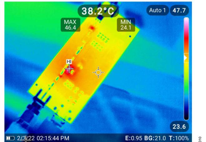
图10. CN0551 热性能 (RF 输入功率 = -10 dBm)
