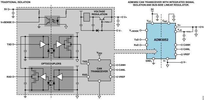
图10. 采用总线电源的传统隔离与ADM3052的比较
