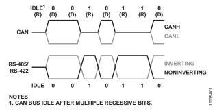
图1. CAN与RS-485/RS-422的差分信号传输比较
