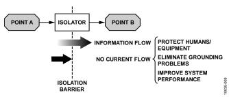
图9. 电流隔离不阻止信息流, 但阻止地电流
