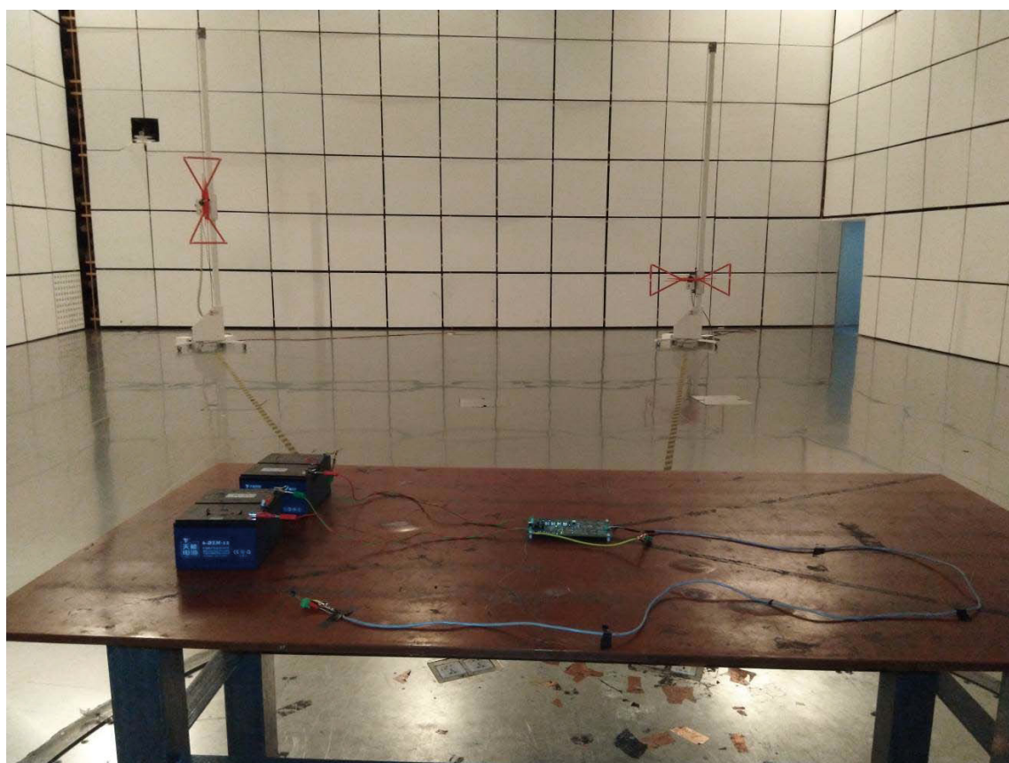
图58. CISPR 11电磁辐射骚扰测试设置照片
