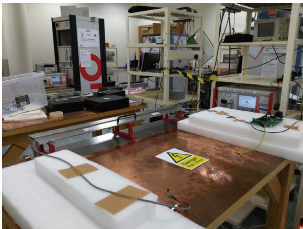
图36. IEC 610004-4测试设置照片
