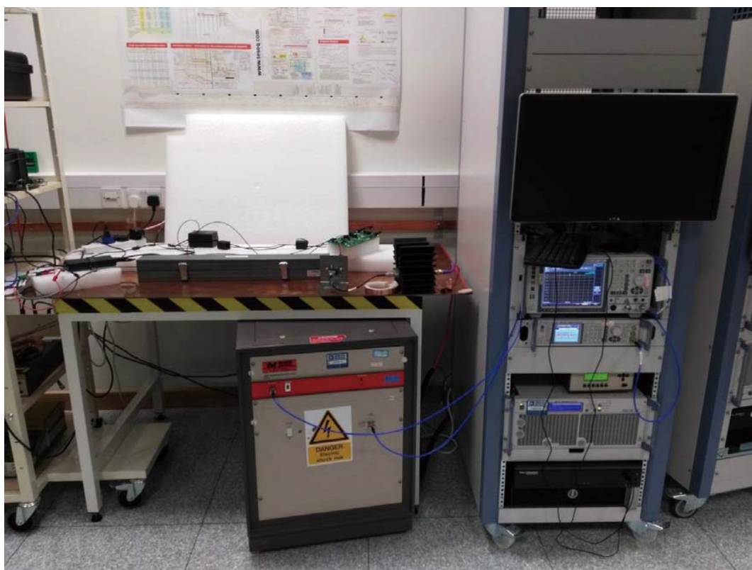
图9. IEC 61000-4-6测试设置照片
