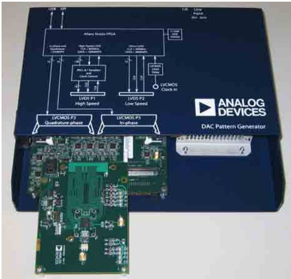
图 38.DAC模式发生器
