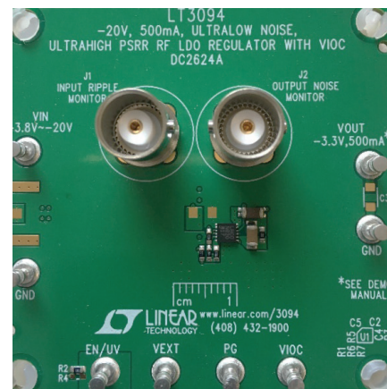
图 2. 演示电路显示了一个 -3.3\text{ V} 微型解决方案。
