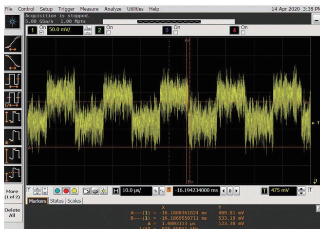
图8. -75 dBm脉冲连续波输入的输出响应
