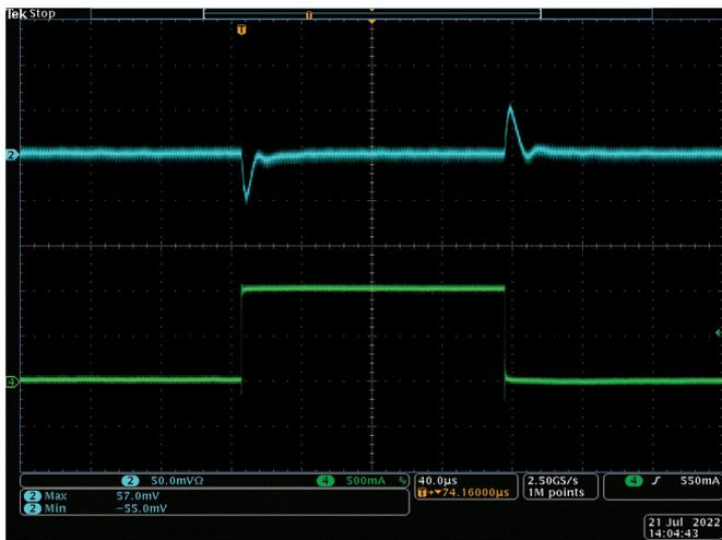
图7. VDD\_1V8瞬态负载响应
