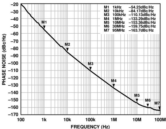
Figure 9. Open-Loop VCO Phase Noise, 8.0 GHz, VCC\_VCO = 5 V
