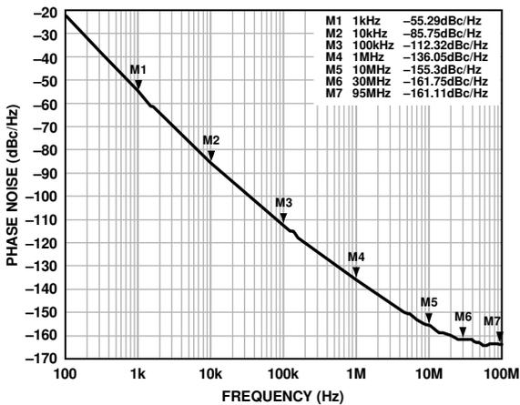
Figure 8. Open-Loop VCO Phase Noise, 5.7 GHz, VCC\_VCO = 5 V
