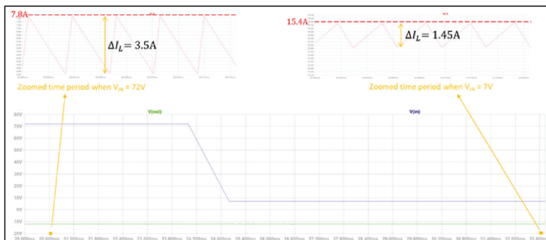
図 10. LTSpice によるシミュレーション結果。図 9 の回路を使用し、 V_{IN} が 7V、72V の場合の \Delta I_L の値を取得しました。 インダクタの電流のピーク値も確認できます。
