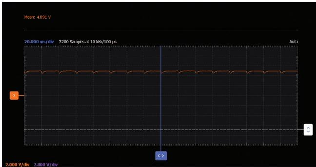
図8. 赤色LEDとダーリントン接続したNPNトランジスタで構成した光センサーの応答（その1）。最も離れた位置からLED光を照射した場合の結果です。
