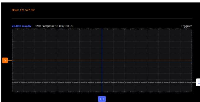
図5. 赤色LEDと単一のNPNトランジスタ（エミッタ接地）で構成した光センサーの応答（その3）。最も近い位置からLED光を照射した場合の結果です。
