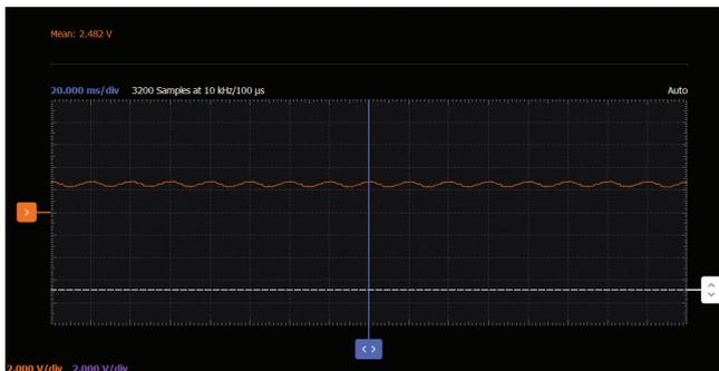
図4. 赤色LEDと単一のNPNトランジスタ（エミッタ接地）で構成した光センサーの応答（その2）。中程度の位置からLED光を照射した場合の結果です。
