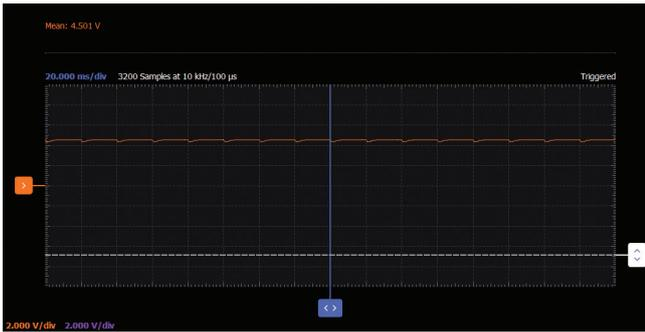
図3. 赤色LEDと単一のNPNトランジスタ（エミッタ接地）で構成した光センサーの応答（その1）。最も離れた位置からLED光を照射した場合の結果です。
