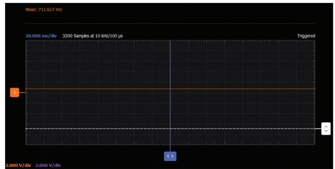
図10. 赤色LEDとダーリントン接続したNPNトランジスタで構成した光センサーの応答（その3）。最も近い位置からLED光を照射した場合の結果です。
