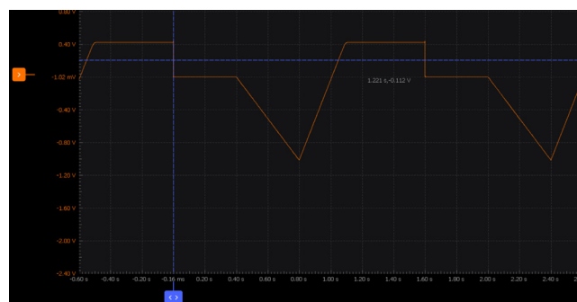
図 31. デュアルスロープ ADC の積分器の出力波形
