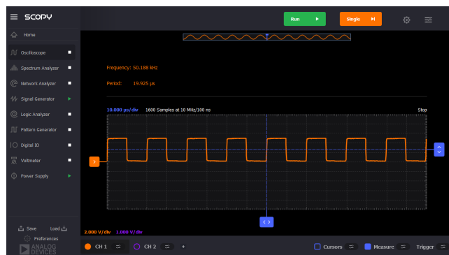
図 13. 0.5V (ハーフ・スケール) の電圧を入力した場合の出力信号
