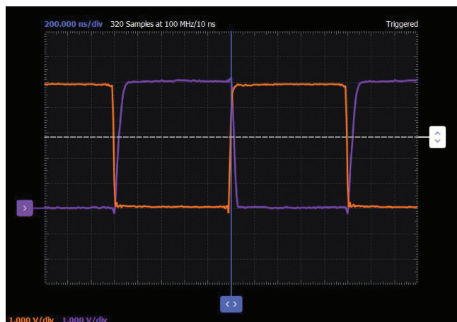
図10. CMOSインバータの入出力波形。伝搬遅延を確認することができます。
