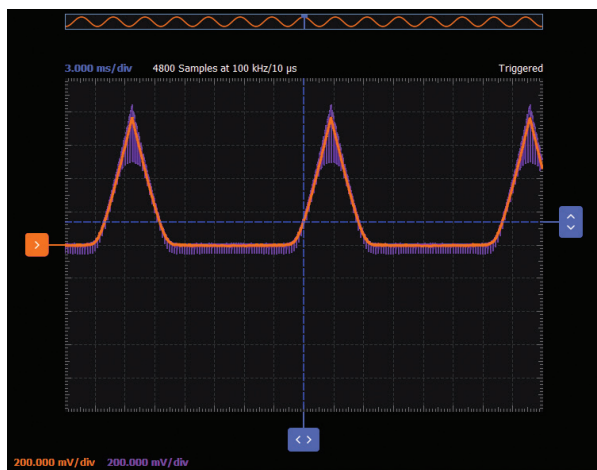
図5. Scopyで取得したカレント・ミラーの信号波形 (W2の周波数は10kHz)
