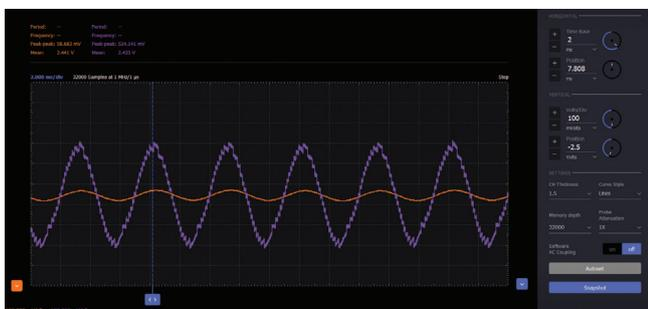
図6. アンプ回路の入出力波形
