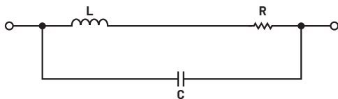
図1. 現実のインダクタのモデル。 L、R、Cの3素子を使って表現しています。
