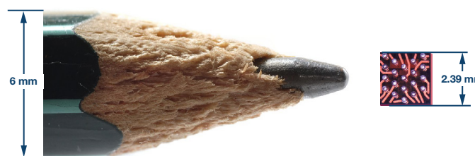
図8. WLCSPを採用したAD7682/AD7689のWLCSPと標準的な鉛筆の比較
