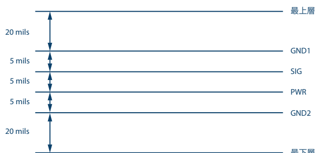
図8. 6層基板の構造
