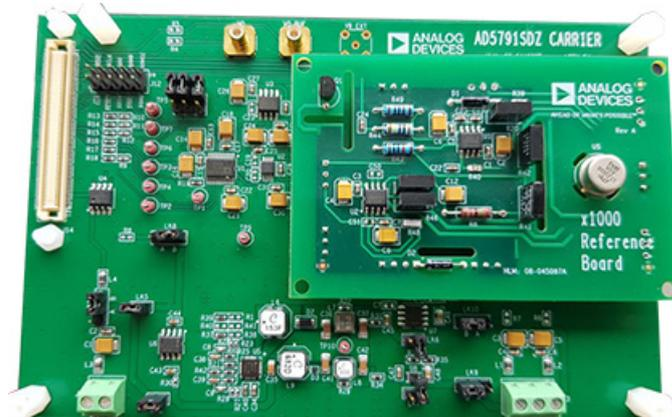
図 8. AD5791 の評価用ボード「EVAL-AD5791SDZ」と LTZ1000 のリファレンス・ボードを組み合わせた様子
