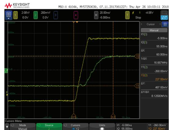
図9. LT6275を使用した場合のセトリング時間 (CH1が入力、CH2が出力)
