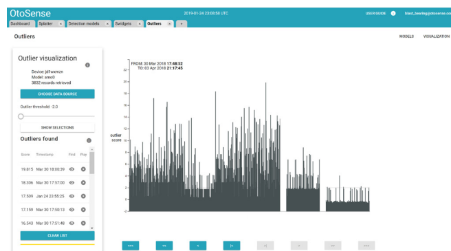
図5. 時系列での音の分析。OtoSenseにおいて異常値を視覚化することで実現しています。
