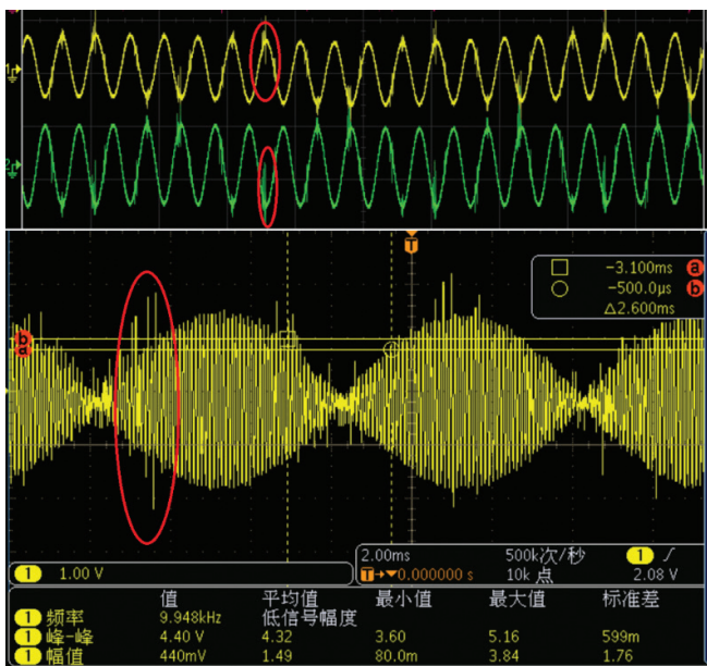
図6. SIN/COSに結合したIGBTに起因する外乱
