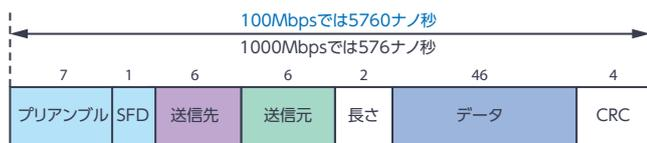
図3. 最小サイズのイーサネット・フレームにおける帯域幅遅延
