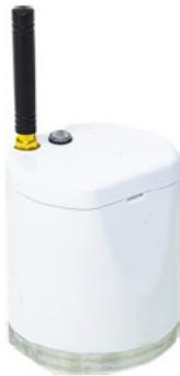
図6. ワイヤレス振動監視システムの評価用プラットフォーム
