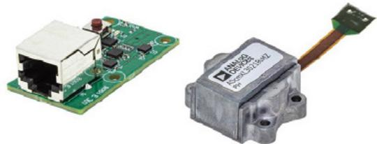
図7. ワイヤード振動監視システムの評価用プラットフォーム
