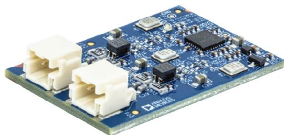
図8. 「EVAL-AD2428WC1BZ」。バスから給電するA<sup>2</sup>Bのスレーブ・ノードとして機能します。I<sup>2</sup>S/TDMには対応しませんが、4個のPDMマイクロフォンを備えています。
