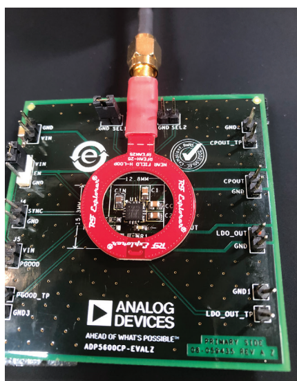
図5. 放射性EMIの測定環境。 ADP5600の評価用ボードとアンテナを使って構成しました。
