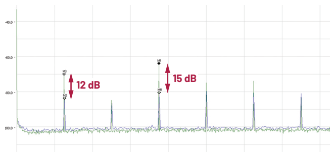
図6. 放射性EMIの実測結果。緑色が標準ICP、青色がIICPの結果です。 V_{IN} = 12V , I_{LOAD} = 50mA , C_{FLY} = C_{OUT} = 2.2 \mu F , f_{SYNC} = 500kHz です。
