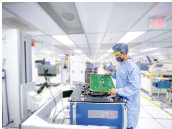
図1. デジタルSoCの検査を担当するオペレータ。テスト用ボードを試験装置に設置する様子を示しています。
