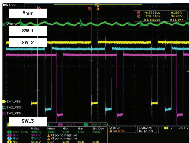
図8. メインのコントローラとエクパンダのスイッチング波形。 入力電圧が44V、出力負荷が63.2A、放電モードの条件で取得しました。
