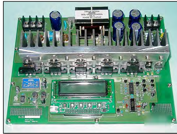
世界初のGaNによるDCDCコンバータ
