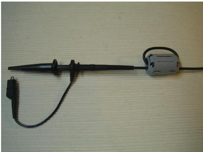
図 10. コモンモードチョークを使ってプロープにコモンモードの対策をしたようす
