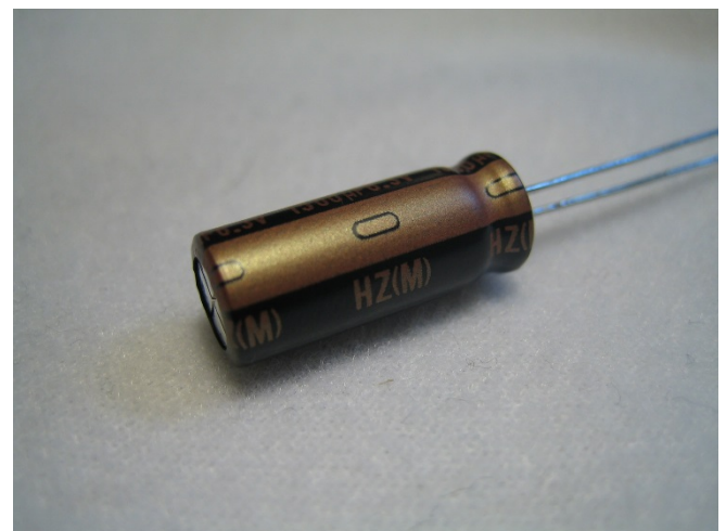
図 9. 注文してあった超 Low ESR コンデンサ (1500μF 6.3V 品)
