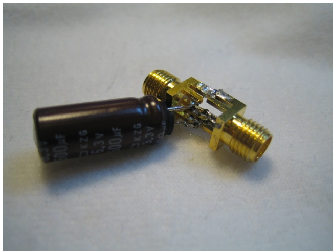
図 7. ネットワーク・アナライザの 50Ω 入出力に 並列にコンデンサを接続して測定してみた
