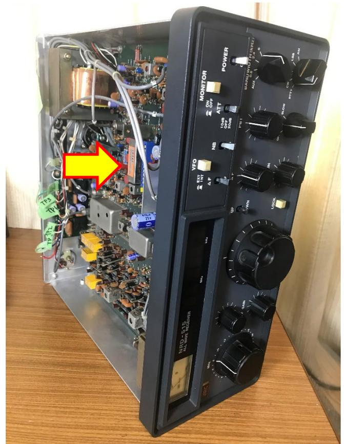
図 18. ヤフオ⑩で落札した JRC NRD-515。「電源入りません、完全ジャンク」という商品。外観は美品ともいえるほどキレイ。ただいま電源のトラブルシュート中の写真。矢印の部分が国際電気の 455kHz SSB 用メカニカル・フィルタ。時代を感じる「メカフィル」です…。そのすぐ右の青い 4mm カード・スロットが CW オプションのカードエッジ基板の挿入部分。ここは何とかしたい！)
