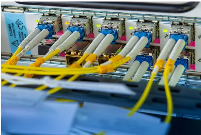
図1. データセンターのネットワークスイッチのSFPTランシーバモジュール(光ケーブルが接続されている)
