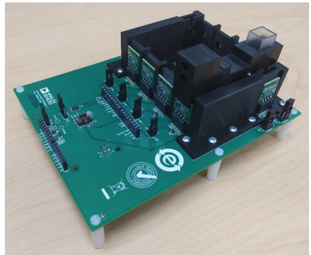
図 9. 組み込みを完了した EVAL-CN0503-ARDZ セットアップ
