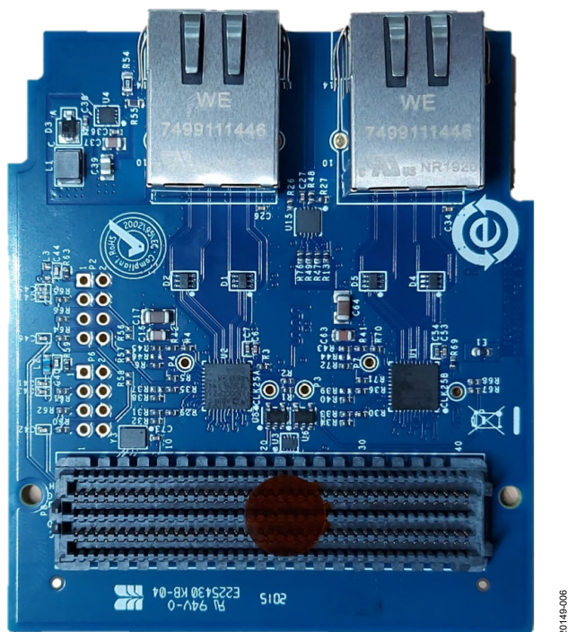
図 6. EVAL-CN0506-FMCZ 回路評価用ボード
