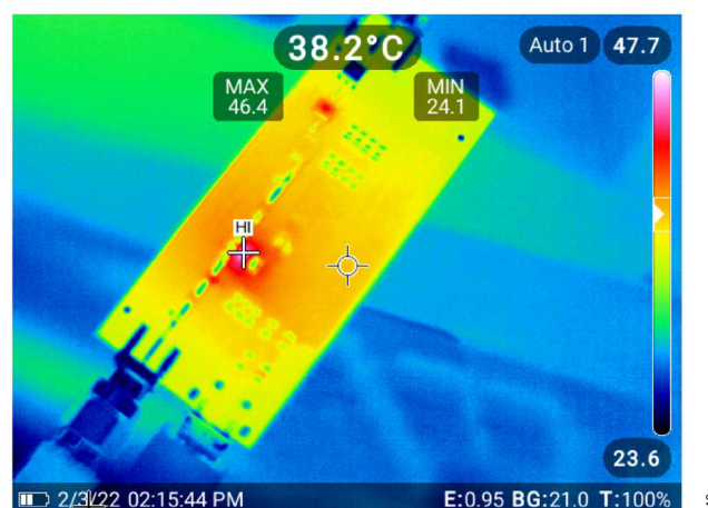
図 10. CN0551 の熱性能 (RF 入力電力 = -10dBm)
