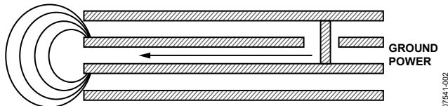
図2. エッジが一致したグラウンドと電源の対からのエッジ放射
